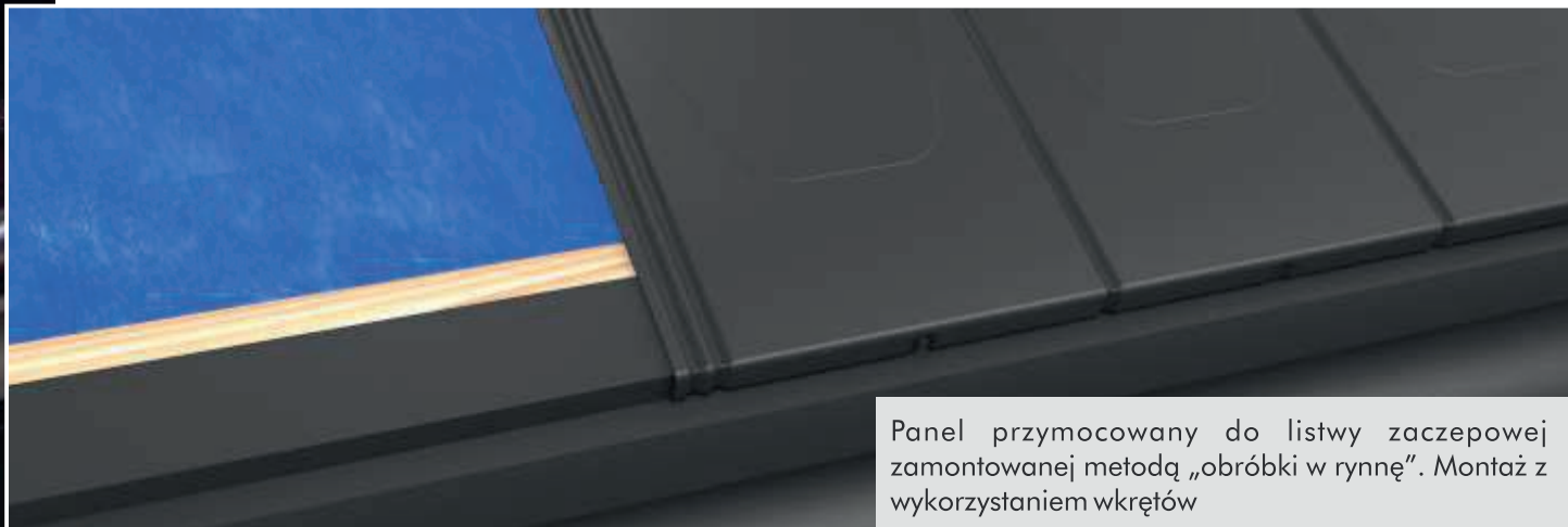
Listwę zaczepową wykonywaną w systemie „obróbki w rynnę” wykonujemy z blachy 0,50mm. Montaż odbywa się od czoła paneli za pomocą wkrętów.
