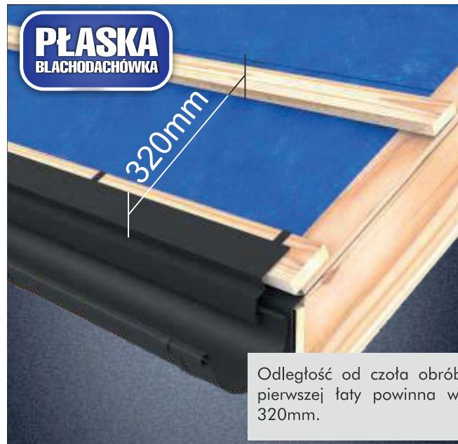
Odległość od czoła obróbki do pierwszej łąaty powinna wynosić 370mm.
