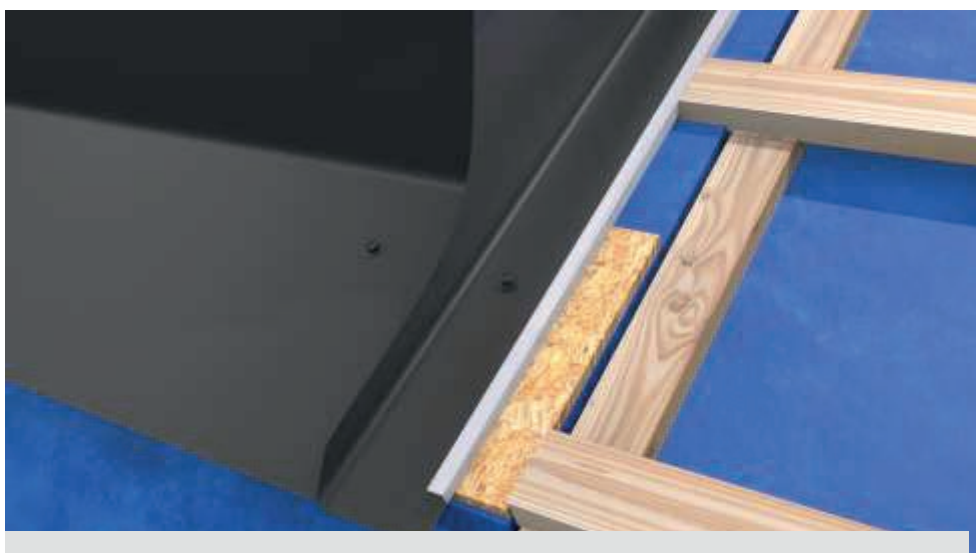
Obróbkę przednią i boczną od przodu montowaną wkrętami do płyty OSB.
